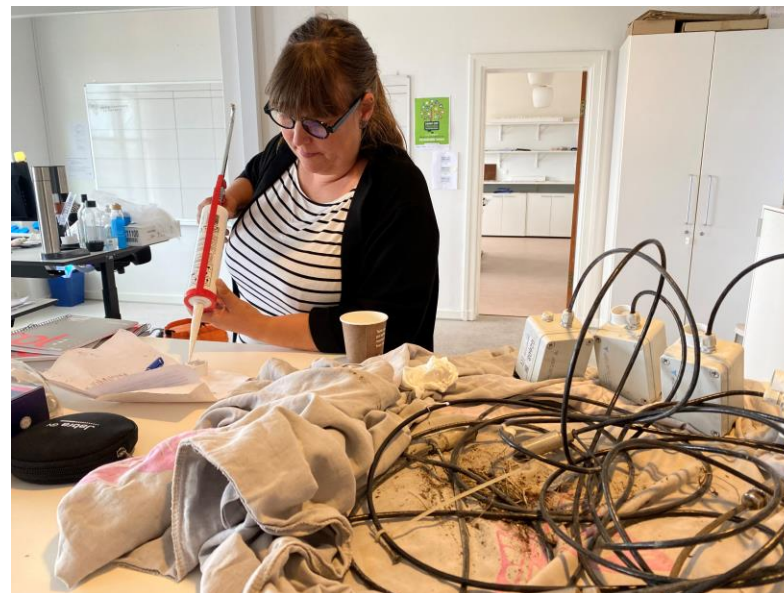
Billederne: Levetidsforlængelse af tryksensor for måling af vandstandshøjder i kommunens regnvandsbassiner
