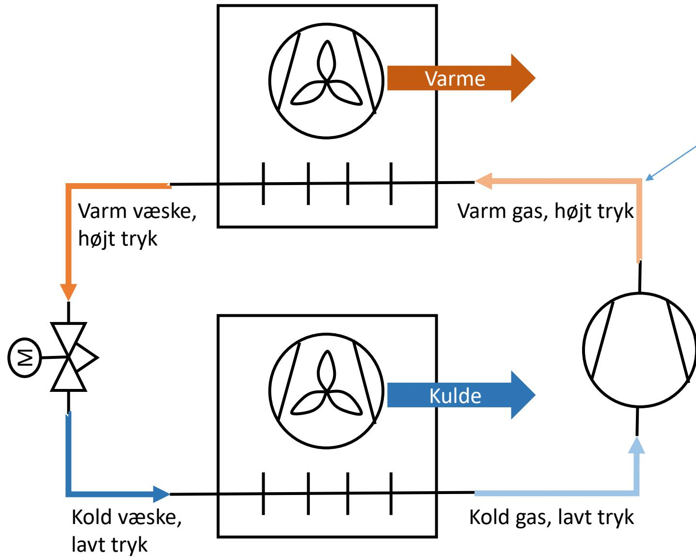
Et kølemiddel er det medie der cirkulere inde i rørene i en varmepumpe eller et kølesystem
